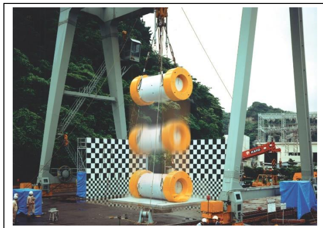
図 A2- 4 実物大鑄鉄キャスクの 9m 落下試験(-40°C)
