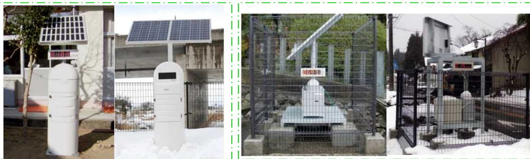
リアルタイム線量測定システム
