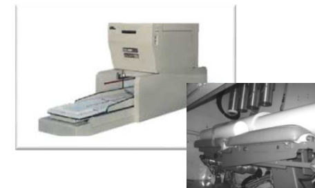
ホールボディカウンタ等設備整備
