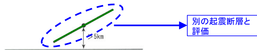
松田(1990)による起震断層の区分基準の模式図 (緑線の断層(群)を同一の起震断層とする。) 吉岡ほか(2005)に一部加筆
