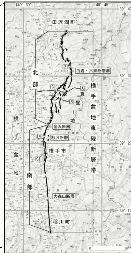
図2 横手盆地東縁断層帯の位置と主な調査地点 1: 十六沢地点 2: 金井伝地点 3: 一丈木・小森地点 4: 谷地中地点 A-C: 反射法弾性波探査測線 A: 文献1 B: 文献9 C: 文献2 ●: 断層帯の北端と南端 ⊕: 北部・南部の境界 ○: 1896年陸羽地震の地表地震断層 断層の位置は文献6及び8に基づく。 基図は国土院発行数値地図200000「秋田」「新庄」を使用。
