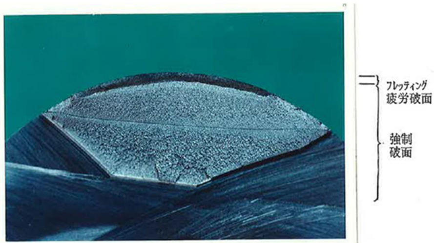
図7 フレット疲労破面例
