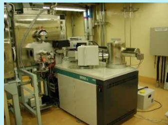
ウラン・プルトニウムの同位体比から濃度等を測定する
