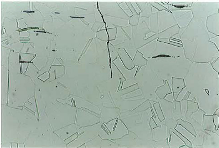
図8 フレッシング疲労き裂の断面マイクロ観察例
