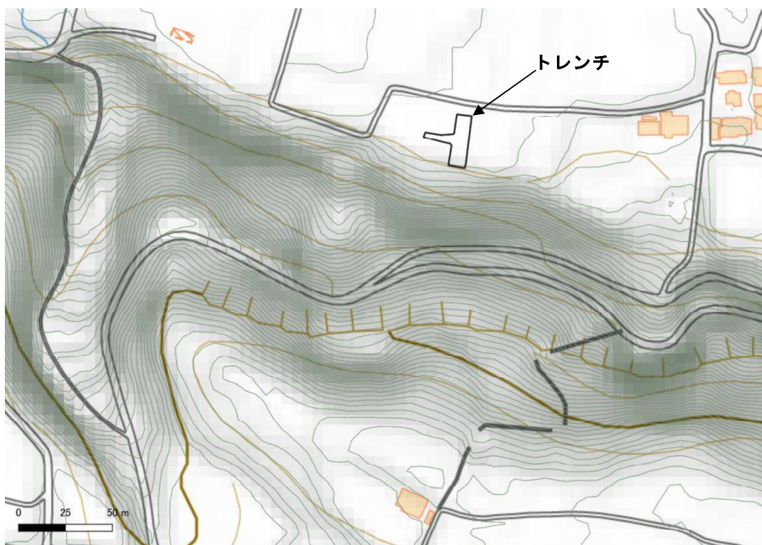
図 2.6.24 トレンチ周辺の 1m 等高線図および傾斜量図
