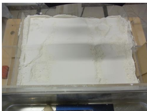
(e) 押し固め後の表面（3から4回程度繰り返す）
