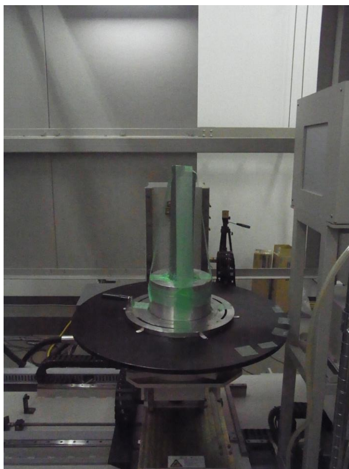
図 3.3.1.2.1 コア試料の撮影状況
