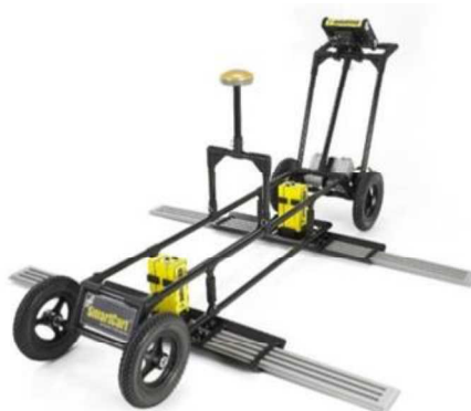
図 2.3.10 地中レーダ探査機器 (pulseEKKO PRO システム)
