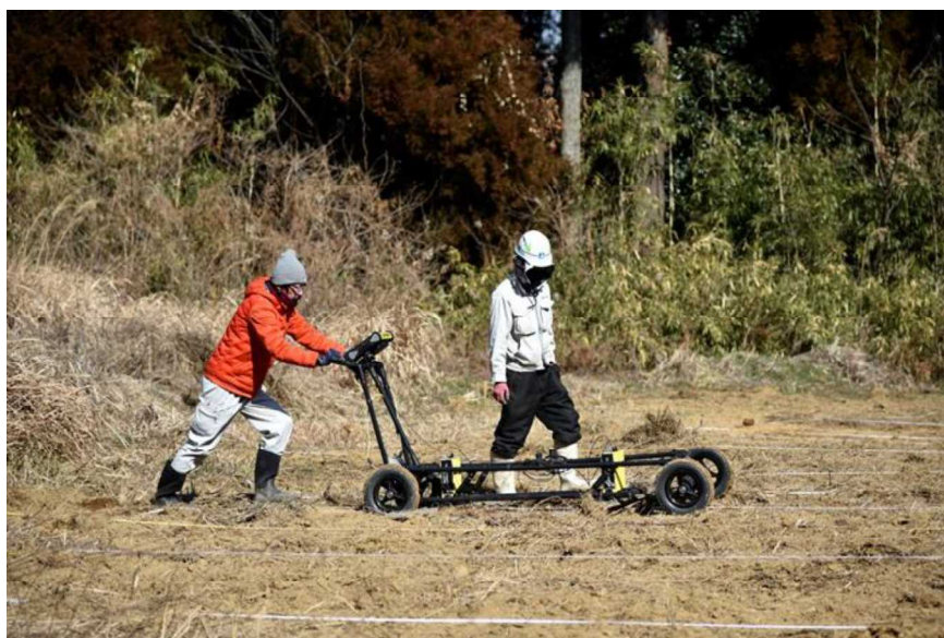
図 2.3.12 地中レーダ探査風景（R3 年度小園地区での探査例，周波数 50MHz）
