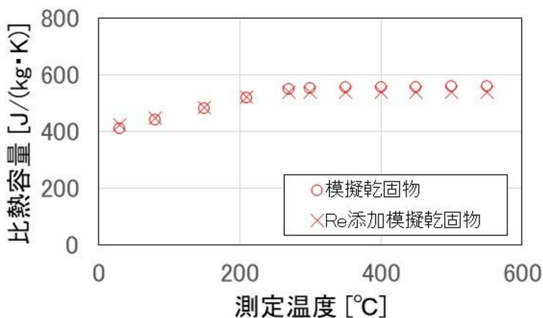
図 5.19 模擬乾固物及び Re 添加模擬乾固物の比熱容量
