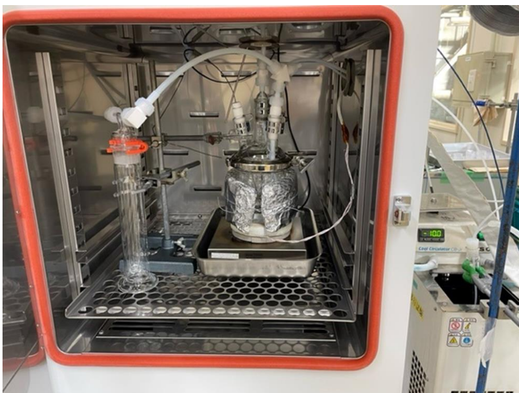
図 2.13 恒温器内と蒸気トラップ部の外観
