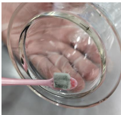
図 3.3 メラミンスポンジを用いた沈着 Ru の回収
