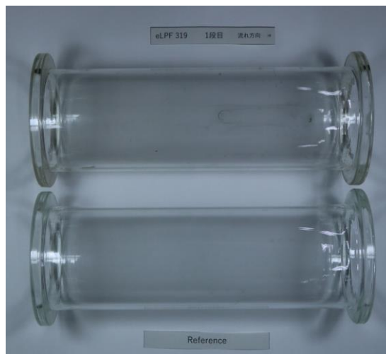
図 3.13 試験 4 終了後の反応管と沈着物
