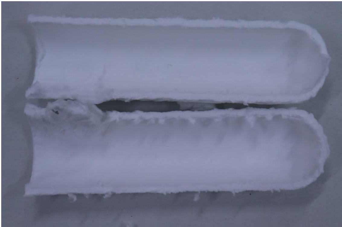
図 3.24 試験後ガラスフィルタ内壁写真 (試験 8)
