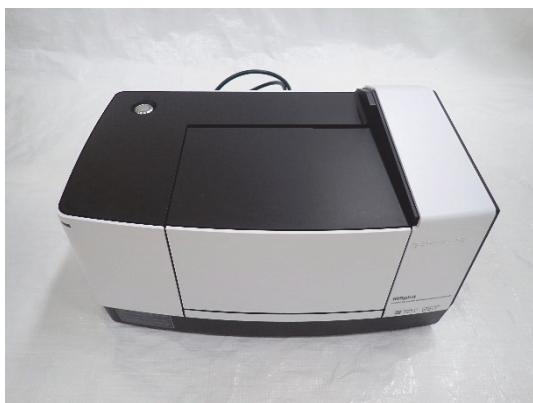
図 9.2-5 フーリエ変換赤外分光光度計及び制御解析用 PC
