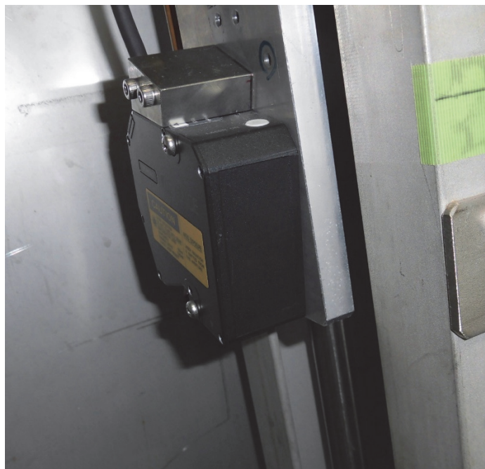
図 6.2.3.1-2 (4/6) モックアップ試験装置：レーザー変位計
