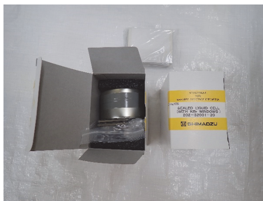
図 9.2-6 試料室窓板（標準タイプ）及び液体用気密セル
