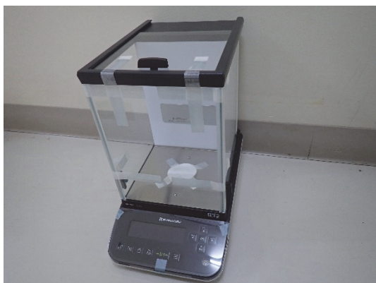
図 9.2-7 分析天秤及びガス置換型電気炉
