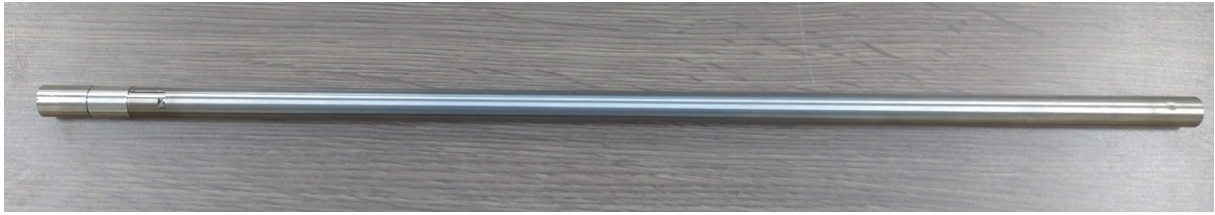
図 6.4.2-4 燃料試料挿入管（短尺）の全体
