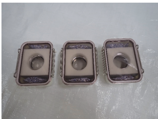
図 9.2-6 試料室窓板（標準タイプ）及び液体用気密セル
