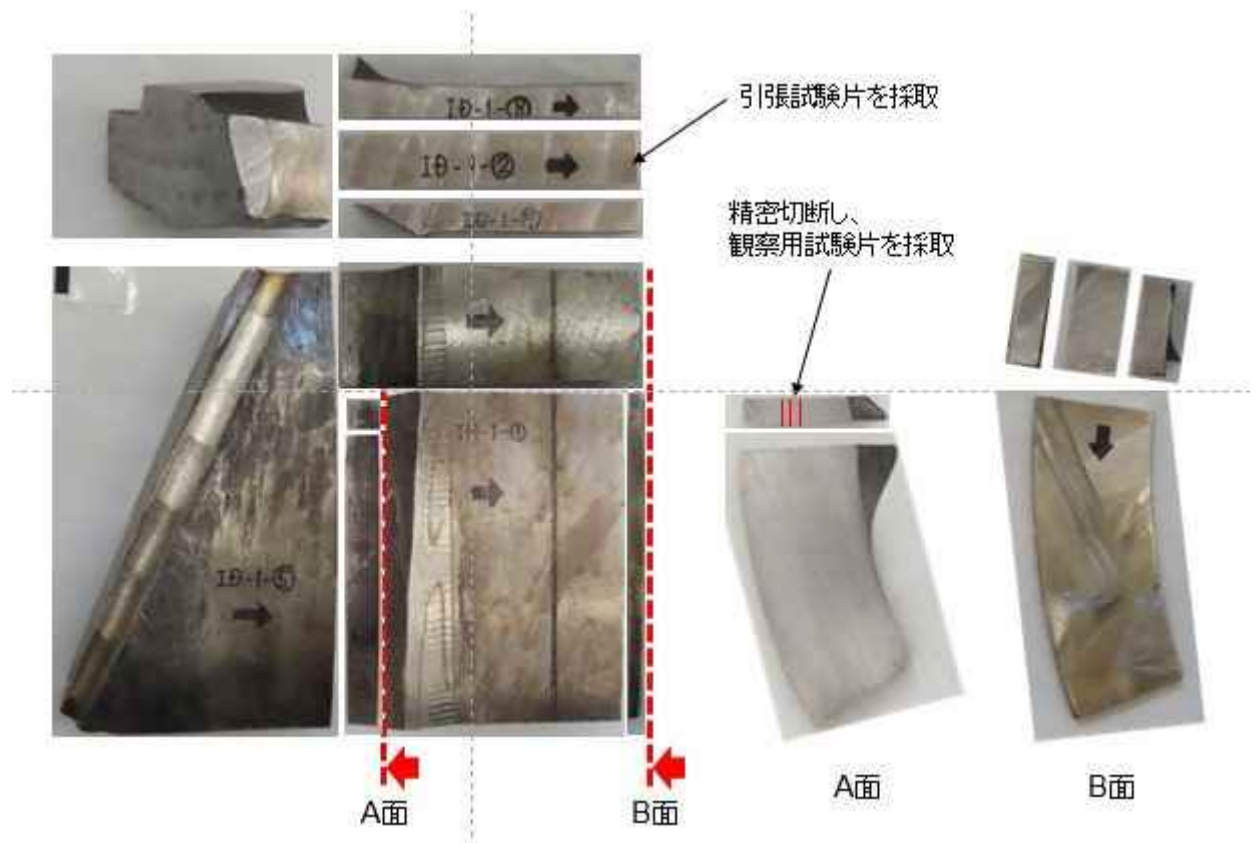
図 3.4.1(2)-9 粗切断後の試験体外観写真 (ID-1)
