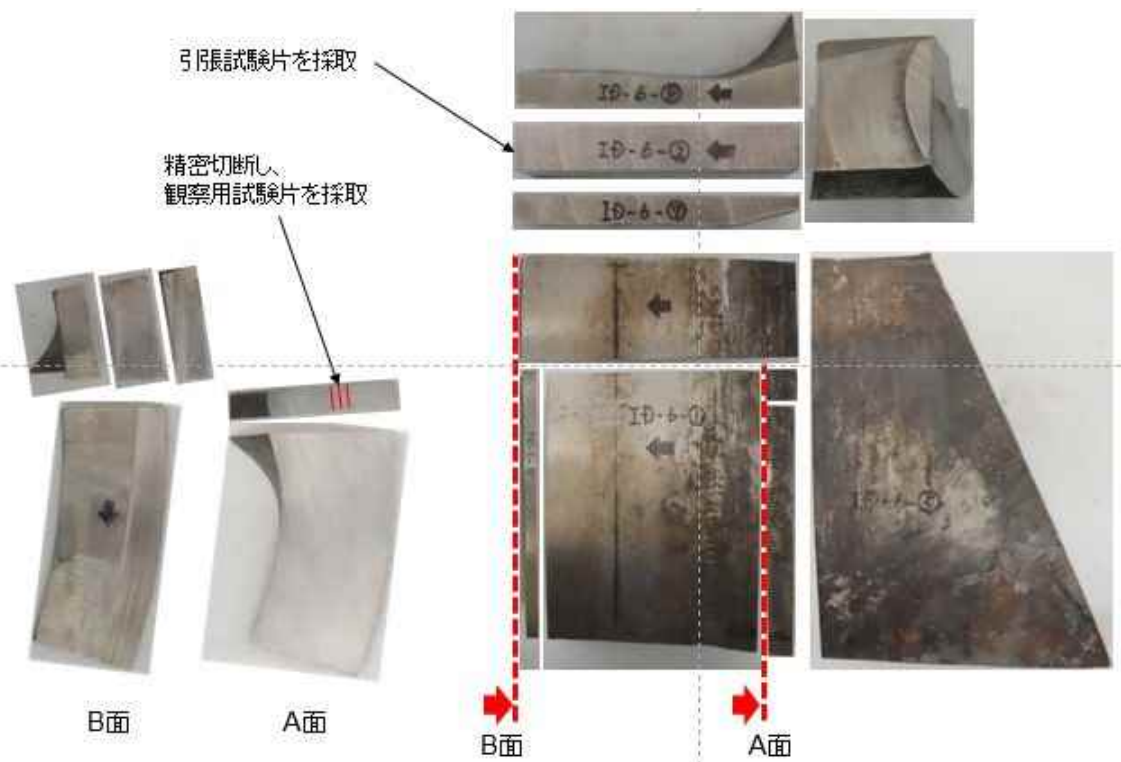
図 3.4.1(2)-14 粗切断後の試験体外観写真 (ID-6)
