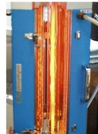
配管の破断などにより冷却水が失われる事故を模擬した燃料棒高温試験の様子
