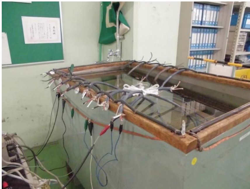
図 2.11 耐電圧試験の実施状況
