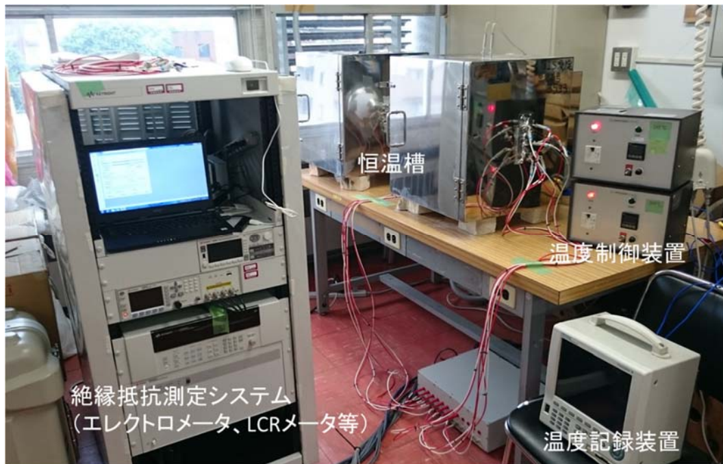
図 2.8 ケーブル大気中加熱試験の装置
