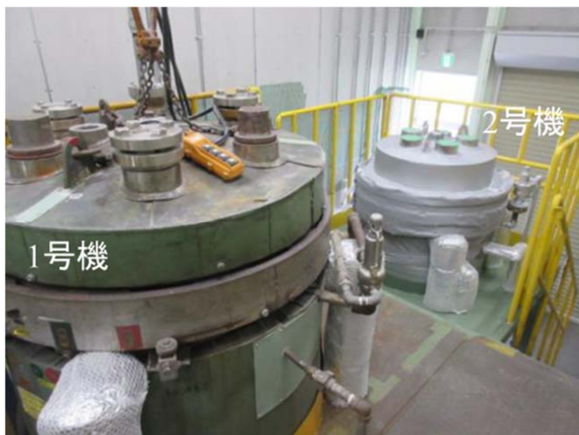
図2.5 蒸気暴露試験装置(日立金属株式会社) Fig. 2.5 Steam exposure chambers (Hitachi Metals, Ltd.)
