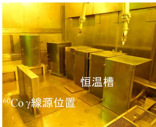
図2.3 ガンマ線照射施設内に設置した恒温槽 (国立研究開発法人量子科学技術研究開発機構高崎量子応用研究所)
