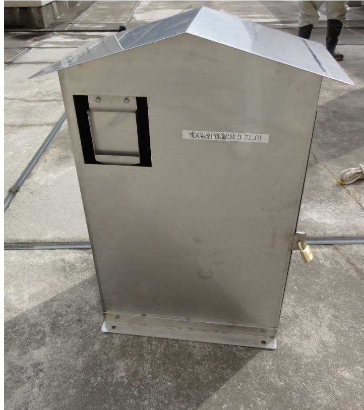
図 4. 1. 4 - 1 飛来塩分捕集器 (土研式塩分捕集器)
