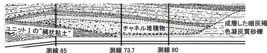
自衛隊駐屯地の露頭に認められるSpflの軽石を含むチャンネル堆積物 (Spflの再堆積層と解釈) (井上ほか,2022)
