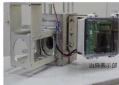
天井測定装置写真 (コリメータ線量計)
