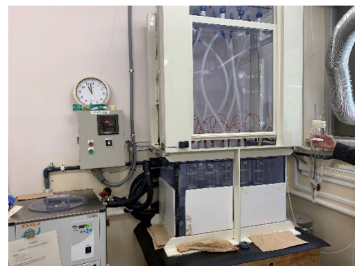
④トリチウムの放射能分析の前処理に用いる 電解濃縮槽
