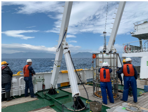
③大型バンドーン採水器の投入
