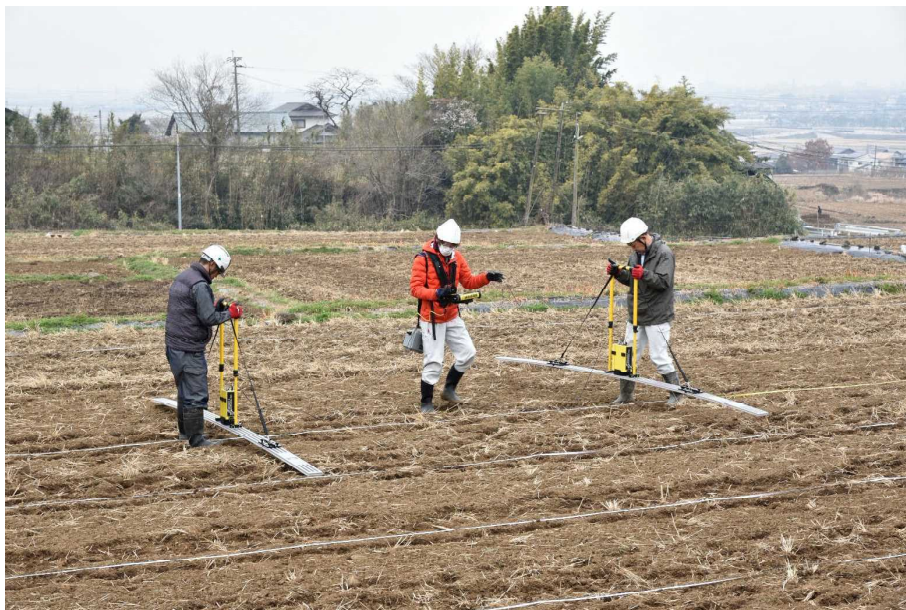
図 2.3.3 手持ちによる方法（使用しているアンテナは 25MHz）
