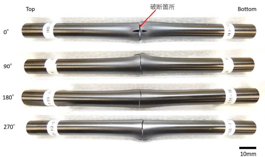
図 4.3.3-7 繰り返し荷重を荷重する四点曲げ試験後の試料外観
