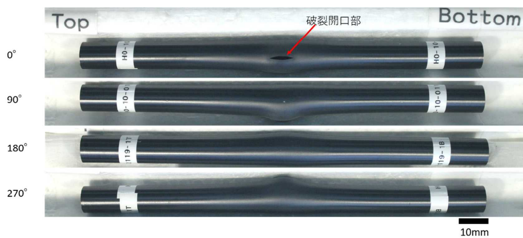
図 4.3.3-3 LOCA 模擬急冷破断試験後の試料外観の例
