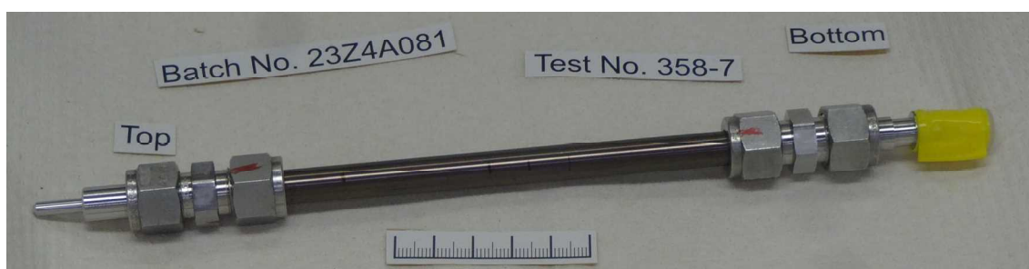
図 4.4.1-2 358-7 試験燃料棒のパルス照射前外観写真
