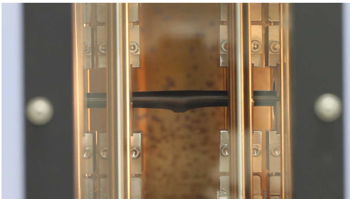
図 4.3.3-5 繰り返し荷重を負荷する四点曲げ試験装置に装荷した試料の外観
