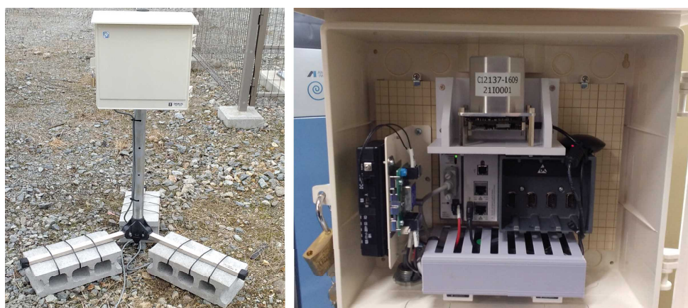
図 38 連続運用中の八角柱型検出器。検出器は昨年までの安全規制研究で開発した可搬型モニタリングポストと同型のもの（左）に内蔵している。検出器は同じ場所に設置されている（右）。松浦電弘社の自社敷地内に設置されている。この箱は防水仕様ではあるが内部の温度管理等は行っていない。この試験が終わった後は石川県が設置するモニタリングポストに隣接しての試験を予定しているため、仮置きでの試験となっている。
