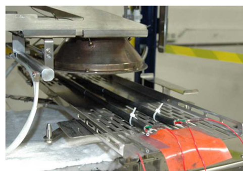
図3 コーンカロリメータによるケーブル熱劣化試験の一例
