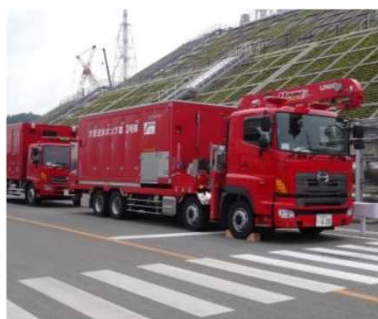
大型送水ポンプ車
