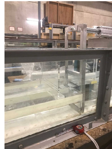
アクチュエータと斜面模型 をつなぐ固定治具
