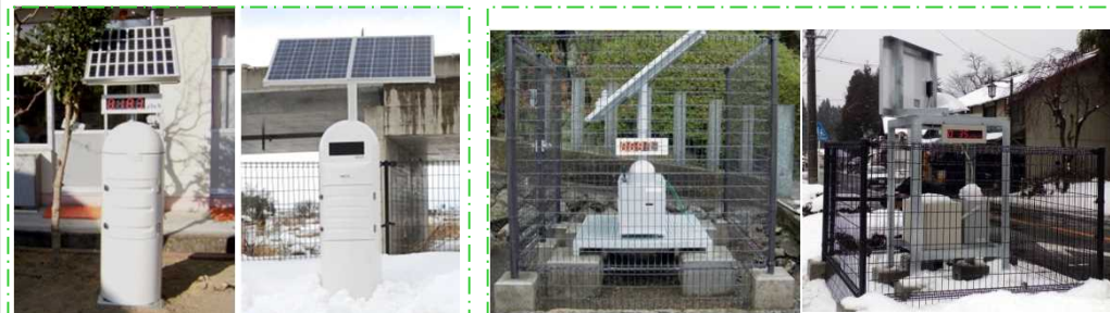
リアルタイム線量測定システム (福島県内 2,929台)
