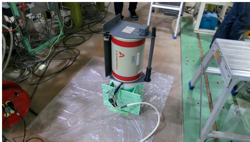
図 2.6 Ge 検出器による床面コンクリートの測定例
