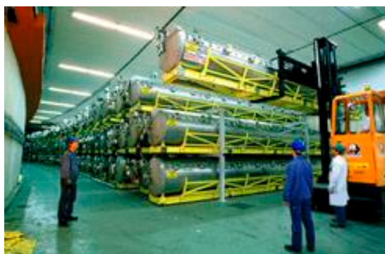
図4.2 保管中の超電導加速空洞
