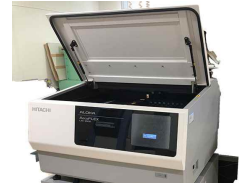
液体シンチレーションカウンタ
