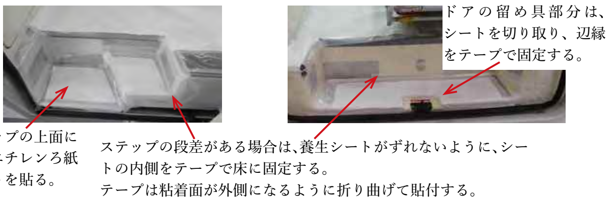
図 3. ステップ部分の養生
