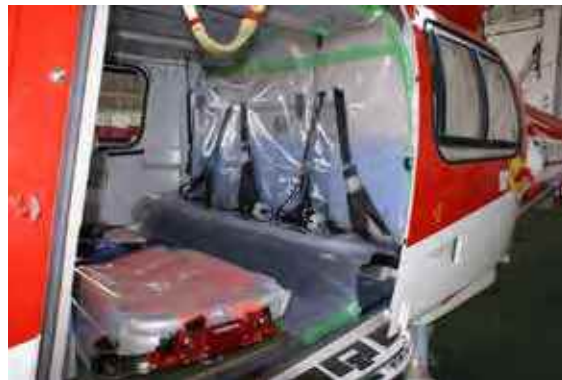
図 22. ヘリコプター壁の養生
