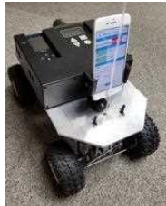
CR警報器をクローラーに設置 リモート会議のアプリを同時起動させ、現場の状況を伝送
