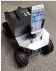
CR警報器をクローラーに設置 リモート会議のアプリを同時起動させ、現場の状況を伝送
