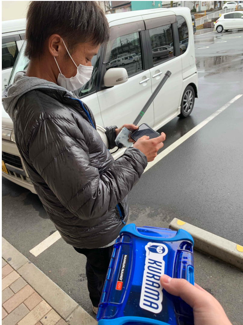
図 50 松江市における超小型 KURAMA-II の実証試験の様子。超小型 KURAMA-II を持ち込んでスマートフォンで測定状況を確認し、通信状況により携行した中継局を近隣に設置して改善の有無を確認した。
