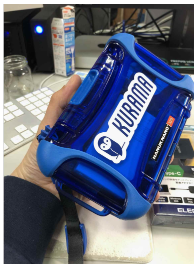
図 44 超小型 KURAMA-II のメインボードに Spresense と検出器および ZETA モジュールを搭載したところ(上)と、Li-ion バッテリー等を実装して防水ケースに組み込んだ様子(下左)およびその外観(下右)。160 mm × 100 mm の葉書大の大きさになっており、容易に携行し設置できる様になっている。
