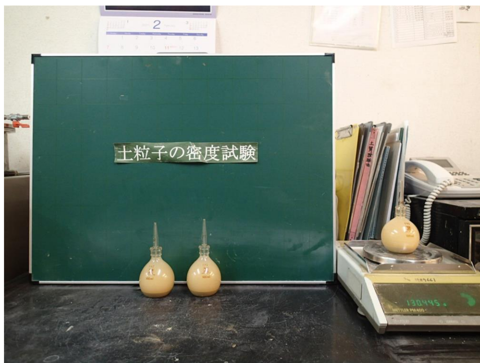
図 3.1.16 土粒子の密度試験 (JIS A 1202:2020)
