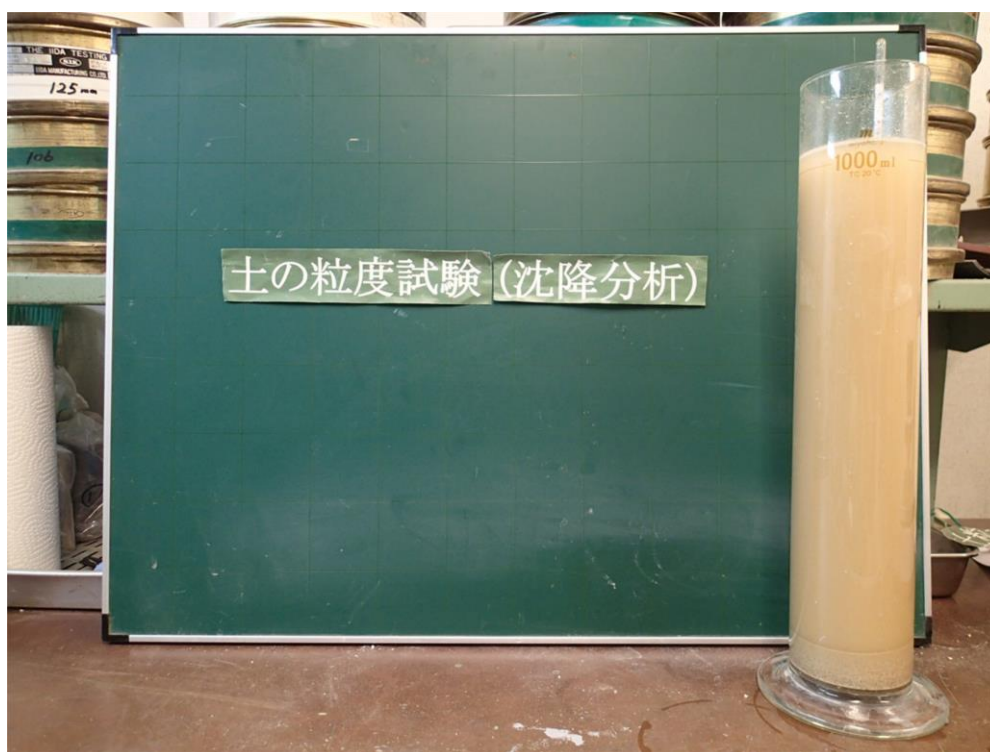
図 3.1.15 土の粒度試験 (沈降分析, JIS A 1204:2020)
