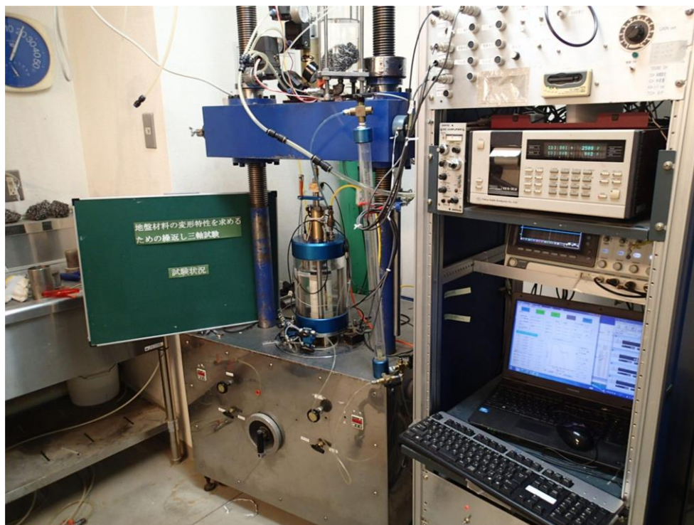
図 3.1.12 土の変形特性を求めるための繰返し三軸試験 (JGS0542-2020)
