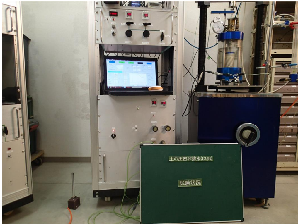
図 3.1.11 土の圧密非排水三軸圧縮試験 (JGS0523-2020)
