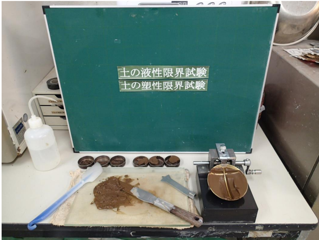
図 3.1.17 土の液性限界・塑性限界試験 (JIS A 1205:2020)
