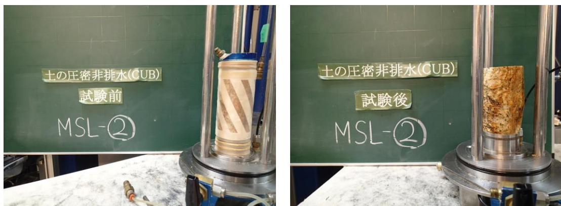
(a) 試験前 (b) 試験後 図 3.1.18 土の圧密非排水三軸圧縮試験 (MSL2)
