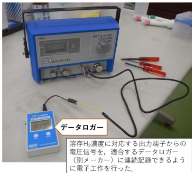
図 4.3.3.-1 計測値ロギング用のデータロガーを追加した溶存水素計
