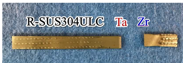
図 2.2.3.23 引張試験において破断した NaOH 浸漬した異材接合材試験片の外観 (浸漬時間 : 168h、熱時効温度 : 80°C、時効時間 : 168h)
