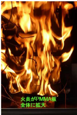
図 2.2.1.13 火炎の様子 (PMMA パネル)
