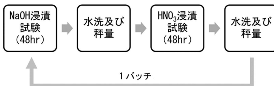
図 2.2.3.1 NaOH と HNO 3 との交互浸漬試験のフロー
