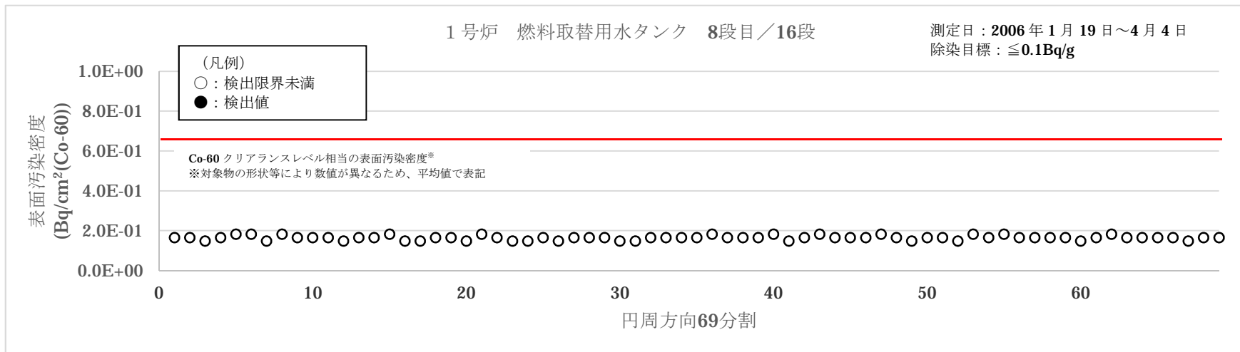
図3 大飯1号炉 燃料取替用水タンク表面汚染密度測定結果 (4/8)
