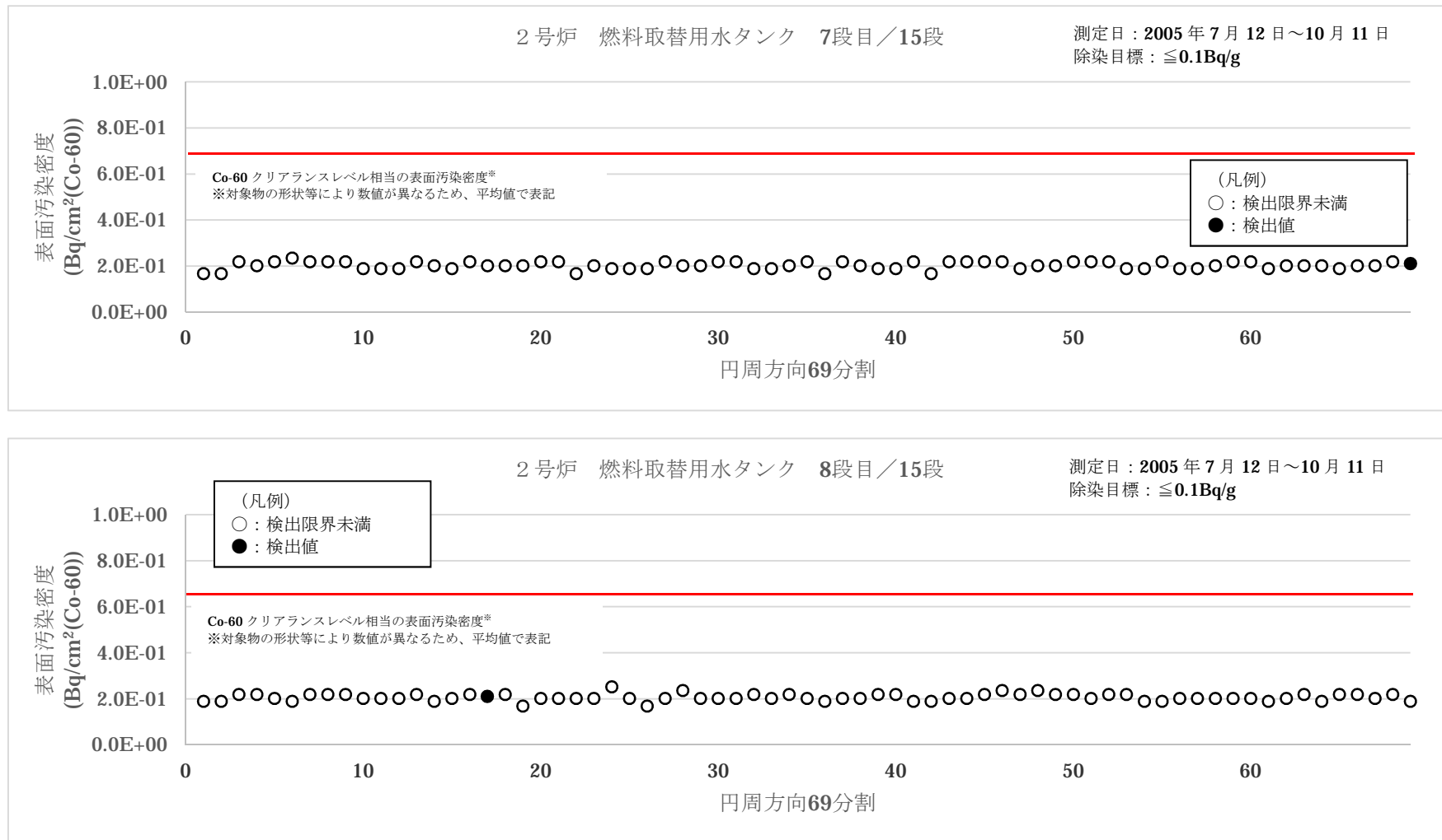
図4 大飯2号炉 燃料取替用水タンク表面汚染密度測定結果 (4/8)
