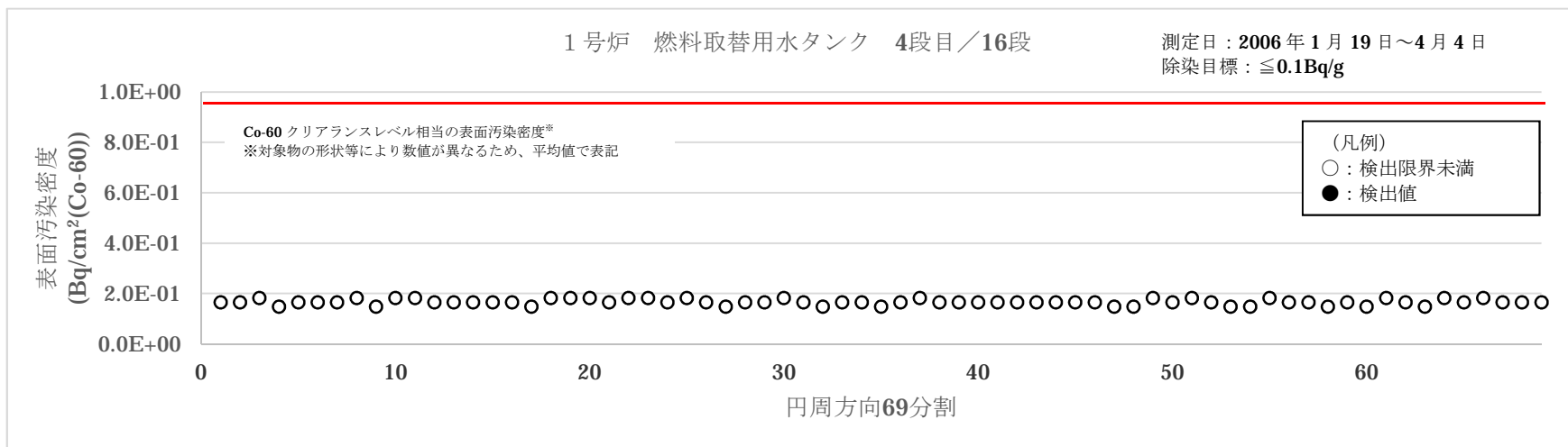
図3 大飯1号炉 燃料取替用水タンク表面汚染密度測定結果 (2/8)
