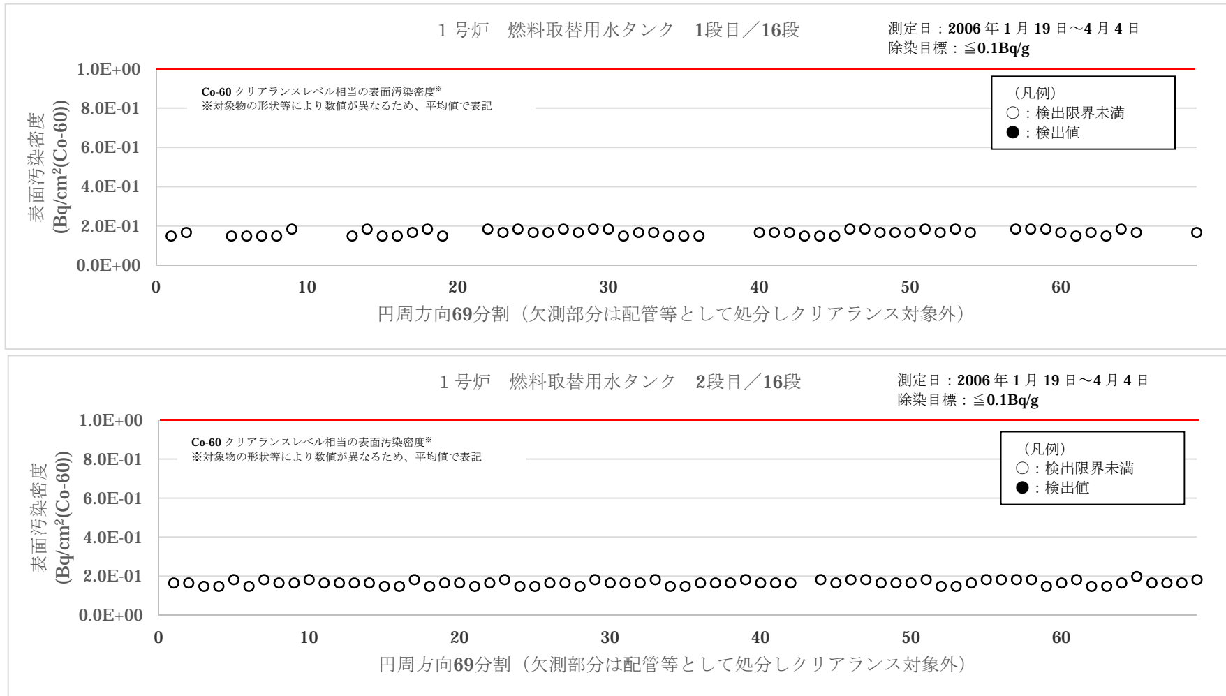
図3 大飯1号炉 燃料取替用水タンク表面汚染密度測定結果 (1/8)
