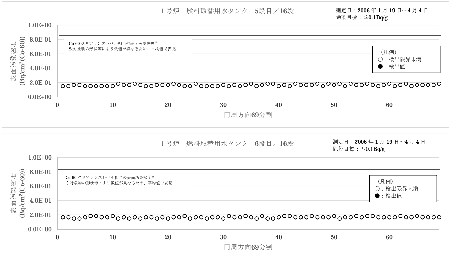
図3 大飯1号炉 燃料取替用水タンク表面汚染密度測定結果 (3/8)
