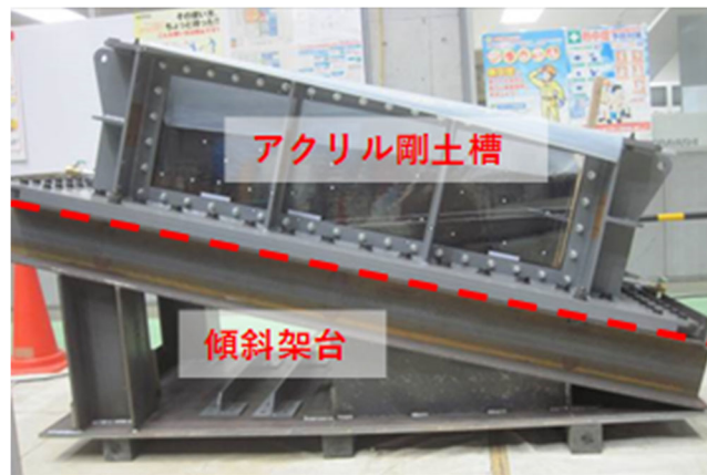
写真 3-1 実験用剛土槽および傾斜用架台
