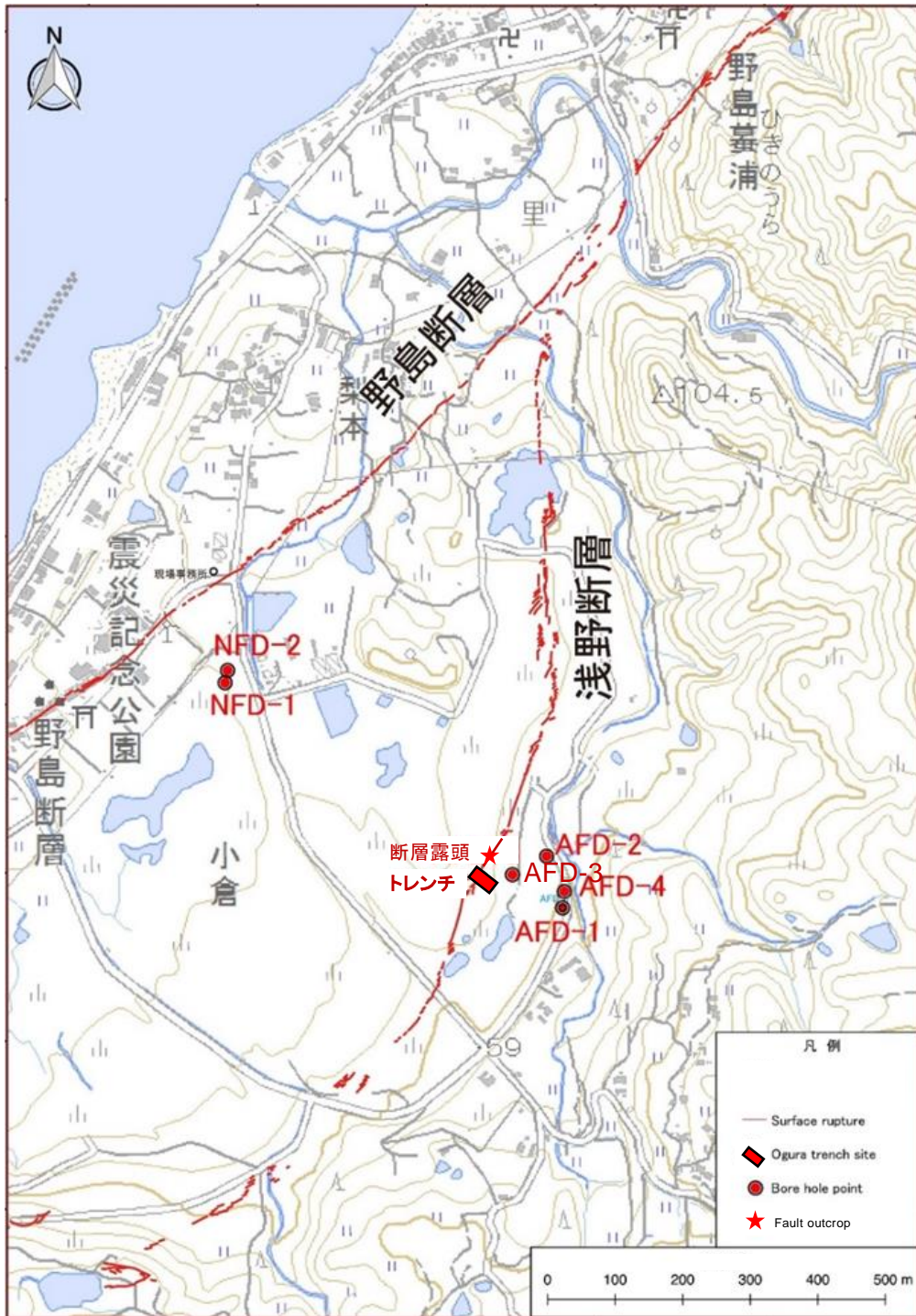
出典) 国土地理院電子国土地形図 28 に栗田・水野(1998) 29 の断層トレース 及び本研究の調査地点を加筆
