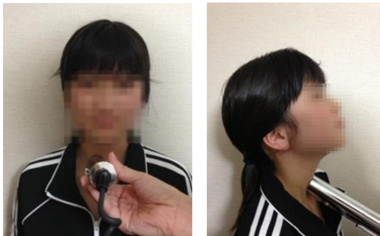
図 7 甲状腺測定におけるプローブ位置
