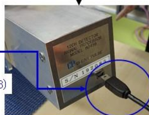
②USB(mini-B)オスを甲状腺モニタの信号処理ユニットのUSBポートに差し込む
