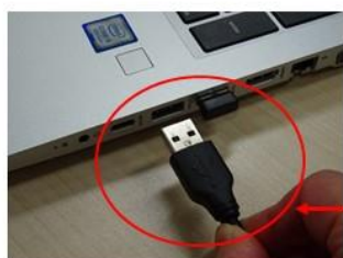
①USB(A)オスを制御用パソコンのUSBポートに差し込む
