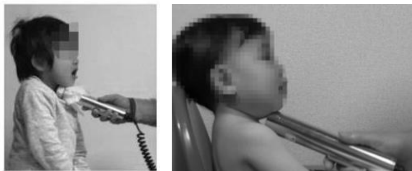
図10 乳幼児を対象とした甲状腺中ヨウ素の計測の状況 —写真中のプローブは TCS-172 のもの (左：4歳男児，右：1歳男児)
