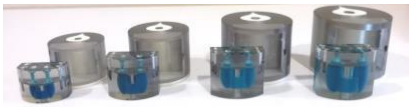
IRSN により開発された年齢別頸部ファントム
