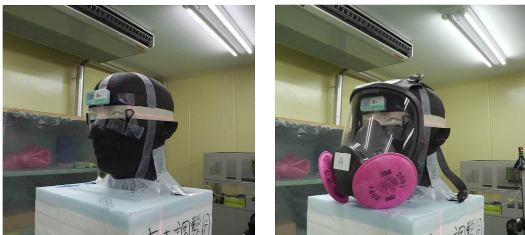
図 3-8 頭部ファントムと個人線量計を用いる \beta 線照射試験の様子 ガラスバッジは額中央, Dosiris は両目尻に取り付けた。また, RANDO ファントム頭部の乳白色部分が組織等価プラスチックで製作した部分である。
