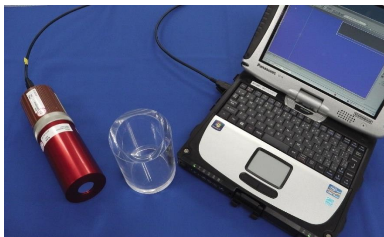
図 3-3 \beta 線スペクトロメータ(プラスチックシンチレータ)
