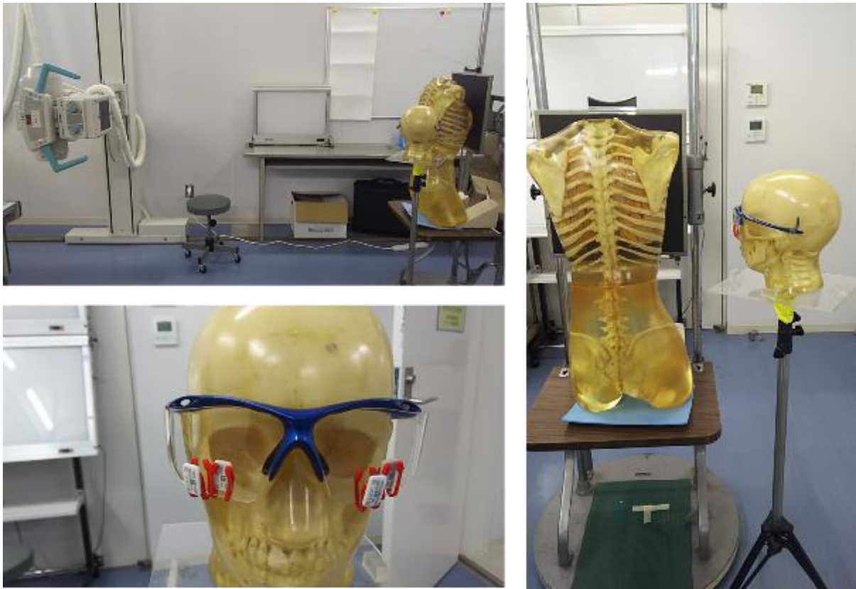
図 5-6 胸部撮影介助時の医療従事者の水晶体線量評価の配置図
