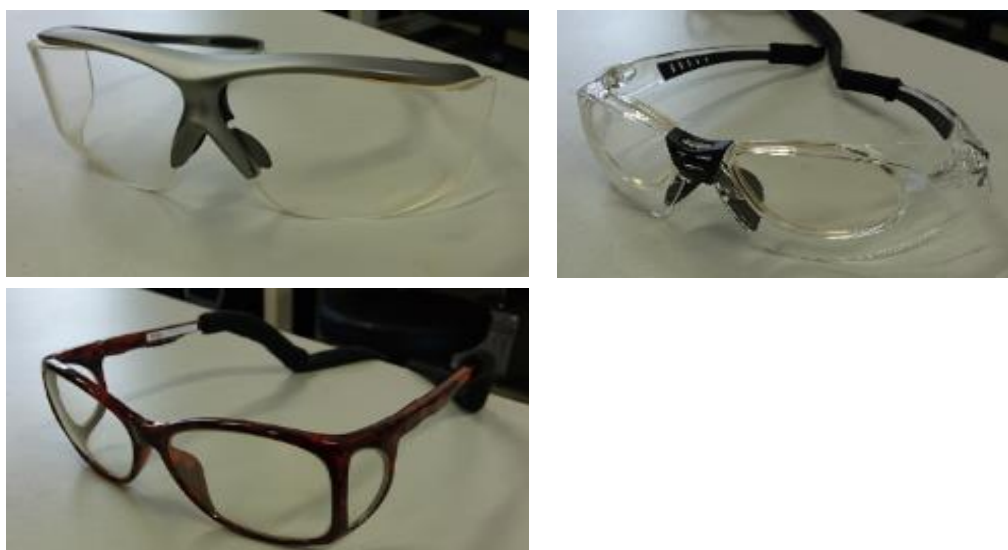
図 5-8 方向別水晶体線量遮蔽能力に使用した防護メガネ 左上：HF400-S、右上：EC-06、左下：PT-53
