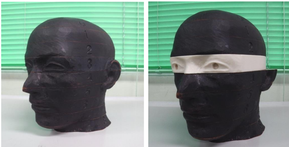
図 3-6 実験で使用した RANDO ファントム頭部 左:オリジナル, 右:乳白色部分が組織等価プラスチックで製作したもの
