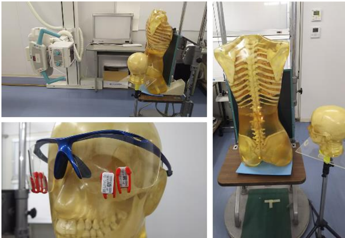
図 5-7 腹部撮影介助時の医療従事者の水晶体線量評価の配置図
