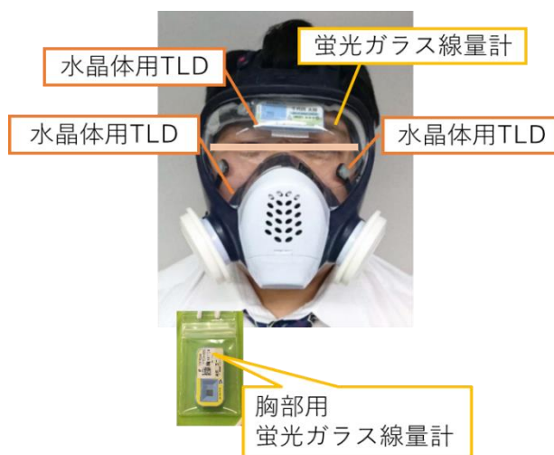
図 2-2 全面マスク装着時の線量計装着方法
