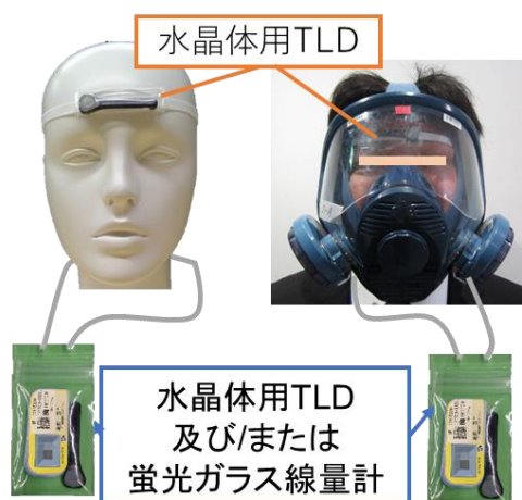
図 2-3 全面マスク未装着時（一時的な全面マスク装着時）の線量計装着方法
