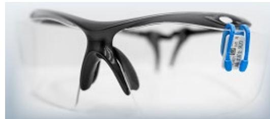
写真 6.1 眼の水晶体専用の受動形個人線量計の例 熱ルミネセンス線量計 A 熱ルミネセンス線量計 B
