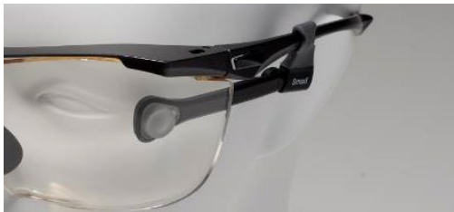
写真 6.1 眼の水晶体専用の受動形個人線量計の例 熱ルミネセンス線量計 A 熱ルミネセンス線量計 B
