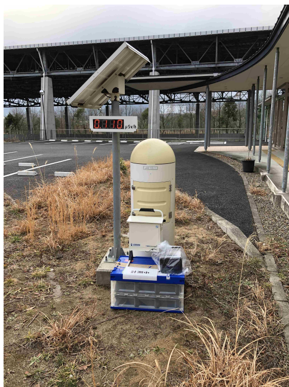
図 17 既設のリアルタイム線量計付近に設置した可搬型モニタリングポスト。設置方法は設置場所の管理者の指示にしたがっており、必ずしも放射線計測に最適化されているわけではないことに注意。
