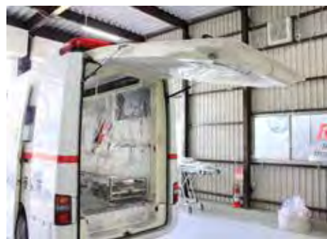
図4 バックドアの養生
