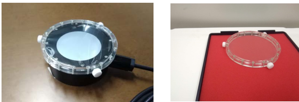
図 21 CE-08 電離箱。70 \mu\text{m} 線量当量測定用フィルタが装着されている (左)、70 \mu\text{m} 線量当量測定用フィルタ単体の写真(右)
