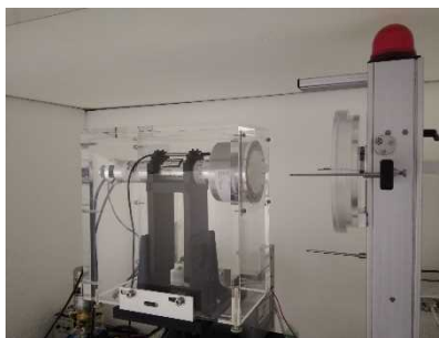
外挿電離箱による測定
