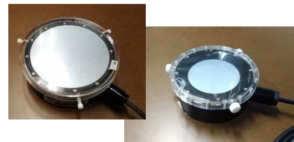
校正定数を測定した電離箱
