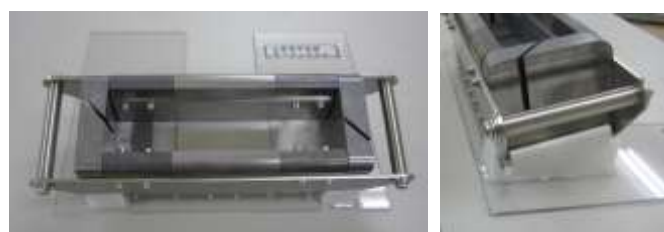
③測定器設置用プレートへの遮蔽体の設置／③遮蔽体右側の設置状況
