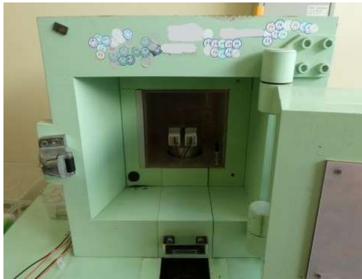
図4-2-3-4-1 Ge 用鉛遮蔽体を用いた LaBr 3 (Ce)シンチレーション検出器の自己バックグラウンド測定の様子
