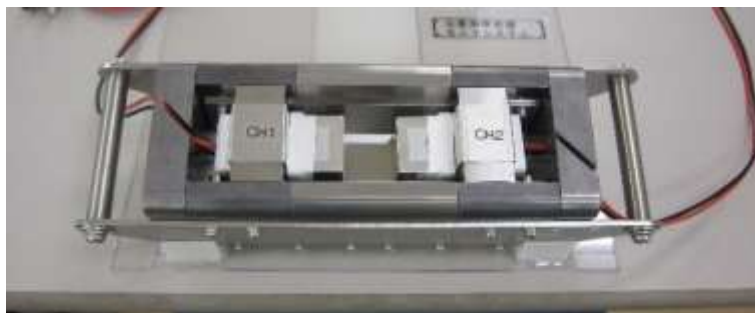
図4-2-2-2-1 今年度新たに製作した公衆用（ \text{LaBr}_3(\text{Ce}) シンチレーション検出器）の検出器遮蔽体
