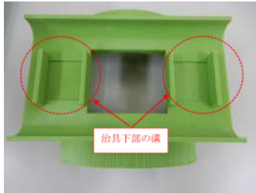
図 3 - 2 - 3 治具下部の溝
