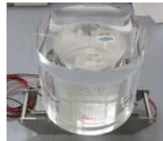
成人用配置 (PMMA20cm \Phi × 17cm)
