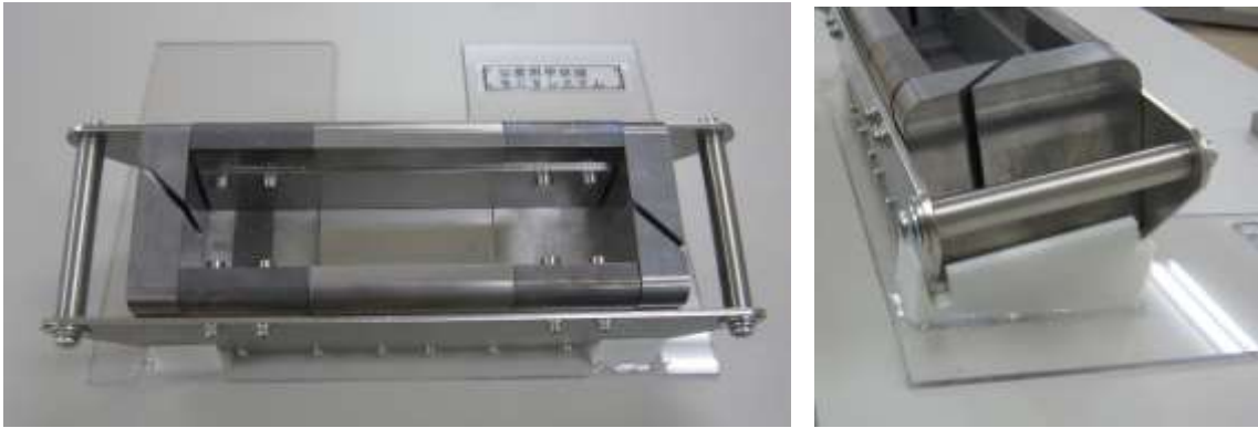
測定器設置用プレートへの遮蔽体の設置／遮蔽体傾斜用台(右側)
