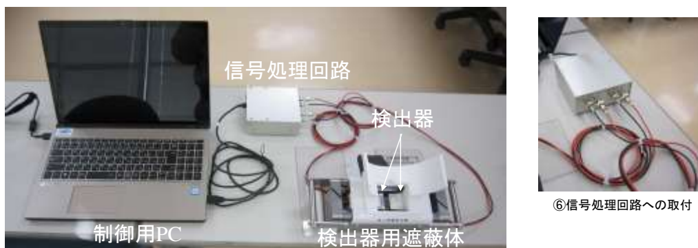
図 3-1-4 甲状腺モニタシステムのセットアップ
