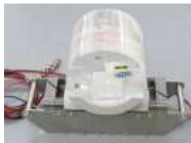
乳児用配置 (PMMA13cm \Phi × 12cm)
