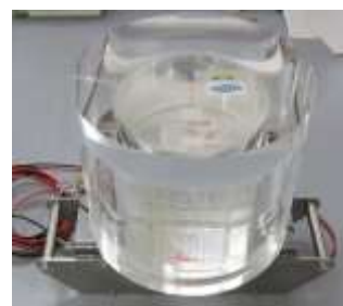
成人用配置 (PMMA20cmΦ × 17cm)
