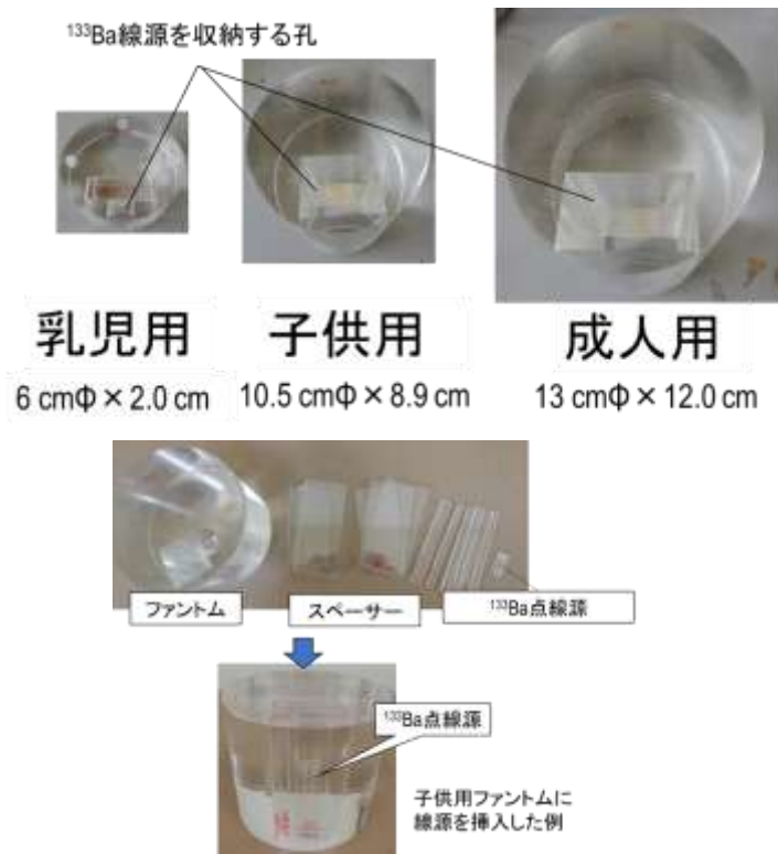
図 3-3-8 甲状腺モニタ校正に使用した簡易物理ファントム（上）とファントムへの 133 Ba 点線源挿入の様子（下）
