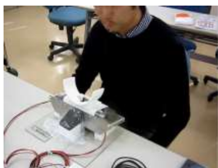
甲状腺モニタへの被検者の保定方法
