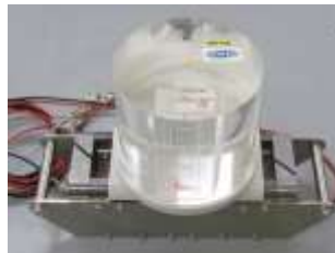
小児用配置 (PMMA13cm \Phi × 12cm)
