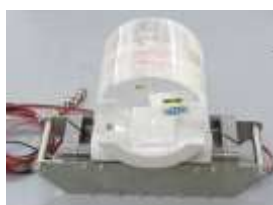
乳児用配置 (PMMA13cmΦ × 12cm)
