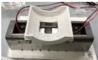
図 4-3-4-1 バックグラウンド補正用測定に使用する治具（左図）及び円筒型 PMMA 製簡易頸部ファントムのセットアップ
