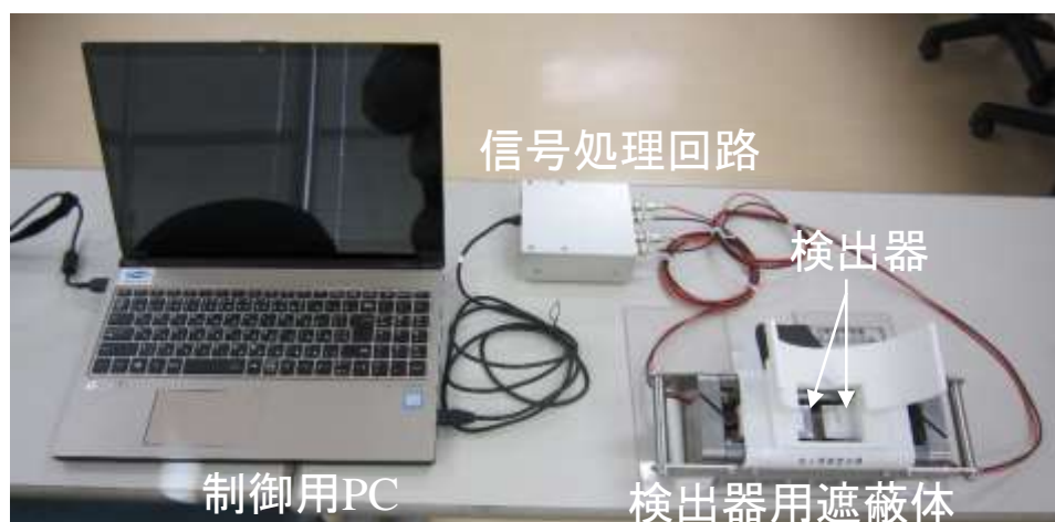
図 2-1 公衆用甲状腺放射性ヨウ素モニタシステムの写真
