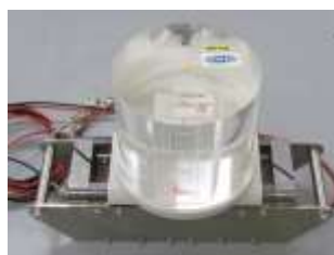
小児用配置 (PMMA13cmΦ × 12cm)
