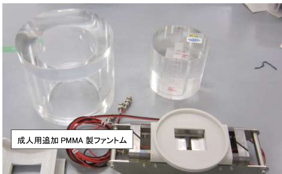
図 4-3-4-2 成人用追加 PMMA 製ファントム (左上)
