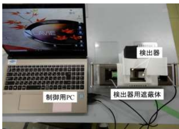
図 3-1-4 甲状腺モニタシステムのセットアップ
