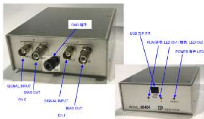
図2-3 信号処理回路の写真
