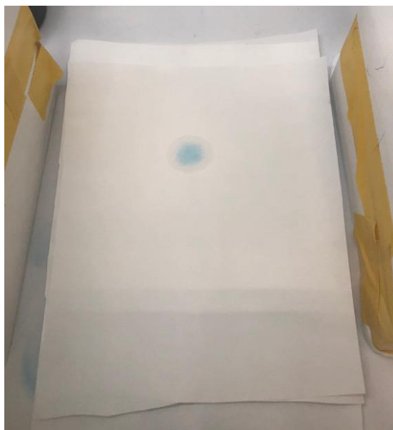
図 5.6-6. ポリエチレン濾紙(二枚重ね)を用いた ^{223}\text{Ra} 汚染拡大防止および汚染除去に関する検討の様子。濾紙上の青色となっている部分に ^{223}\text{Ra} 溶液 10 kBq/100 \mu\text{L} を 100 \mu\text{L} 滴下した。二枚目の濾紙への汚染拡大のほか、 ^{223}\text{Ra} 溶液の滴下位置の左右の部分を持ち離して汚染拡大しているかどうかを \alpha 線サーベイメータにより確認した。
