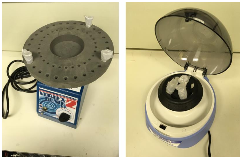
図 5.3-4. (左) 振とう操作の装置セットアップ, (右) 遠心分離操作の装置セットアップ外観
