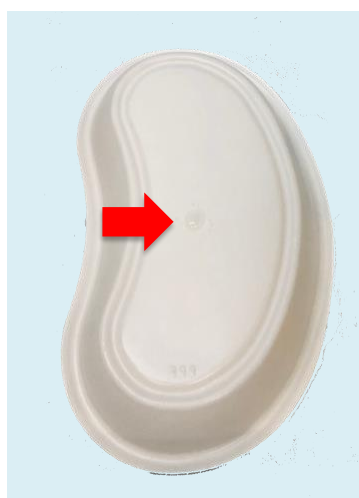
図 5.6-7. ポリプロピレン製膿盆を用いた ^{223}\text{Ra} 汚染除去に関する検討の様子。赤矢印の部分に ^{223}\text{Ra} 溶液 10 kBq/100 \mu\text{L} を 100 \mu\text{L} 滴下し、種々の除染作業後に \alpha 線サーベイメータによる計測を行った。
