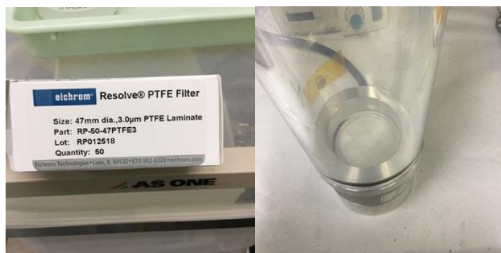
図 5.4-4. 本研究にて使用した \alpha 線放出核種捕集用の PTFE フィルターと装着例
