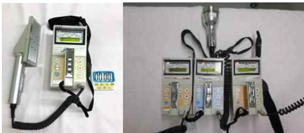
図 3.5-2 測定に使用した \alpha 線サーベイメータ(TCS-232B)および GM 管式サーベイメータ(TGS-146B)
