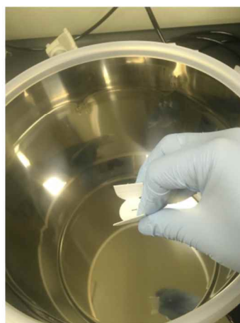
図 3.2-12 汚染検査方法 (左図： \alpha サーベイ、右図：スミヤ法)
