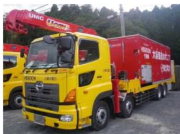
大容量送水ポンプ(タイプ I)
