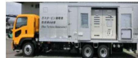
ガスタービン発電機
